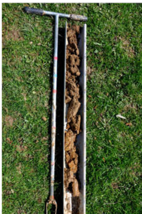
s104-1 – LUVISOL dégradé rédoxique pachique – HyIVc
