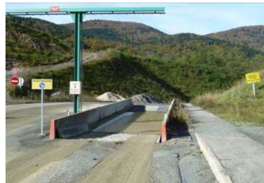
Laveur de roue et rampe d'aspersion pour limiter les envois de poussières (ENCEM)
